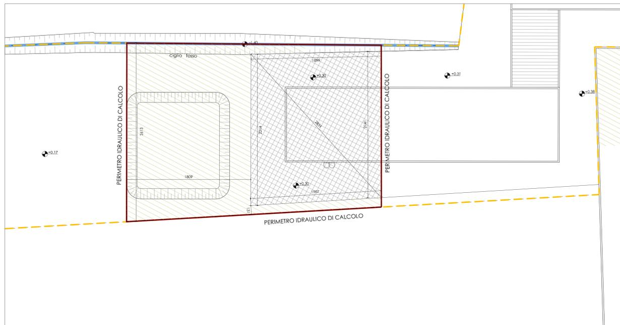
CALCOLO SUPERFICI PER INVARIANZA IDRAULICA - scala 1:200
